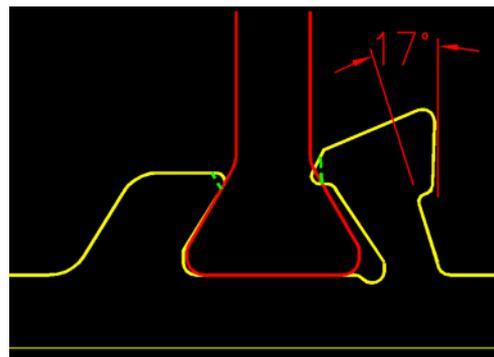
图10 隔热型材滚压后情形
